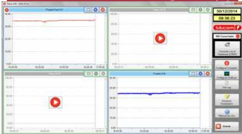
El sistema de medición y registro de temperaturas por puerto USB denominado **Temp USB**, se utiliza para poder ver, y registrar en tiempo real, temperaturas de productos tales como: heladeras, electrodomésticos, equipamiento electrónico, luminarias, máquinas herramientas, etc.
