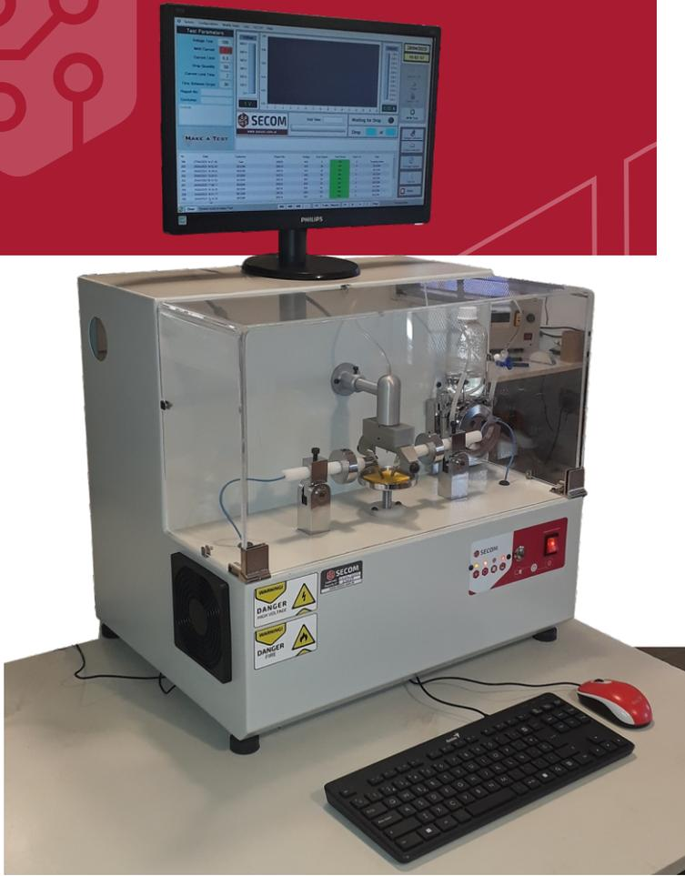
El equipo **EEE 01 - Encaminamiento Eléctrico**, es un equipo totalmente automatizado para los ensayos relativos al encaminamiento eléctrico en aparatos eléctricos. Método para la determinación de los índices de resistencia y ensayo de encaminamiento eléctrico en condiciones húmedas.
