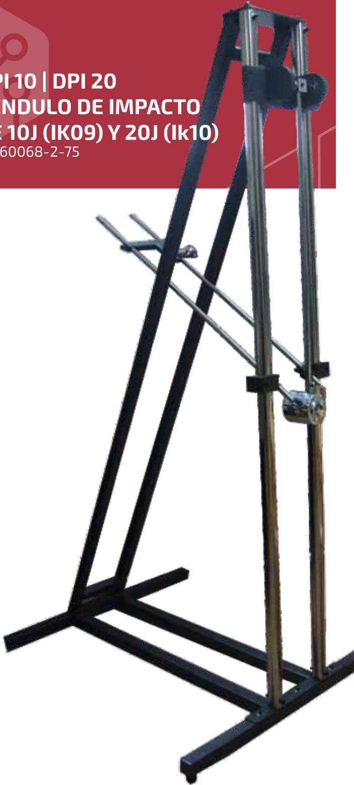
Péndulo de Impacto 10J y 20J (Impact Test Apparatus / Pendulum Hammer) desarrollado y fabricado según la norma **IEC 60068-2-75**.
