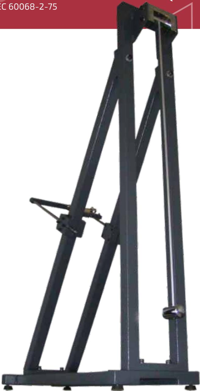
Péndulo de Impacto 2J (Impact Test Apparatus / Pendulum Hammer) desarrollado y fabricado según la norma **IEC 60068-2-75**.
